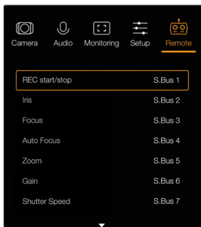
Impostazioni di controllo a distanza Remote di Blackmagic Micro Studio Camera 4K
